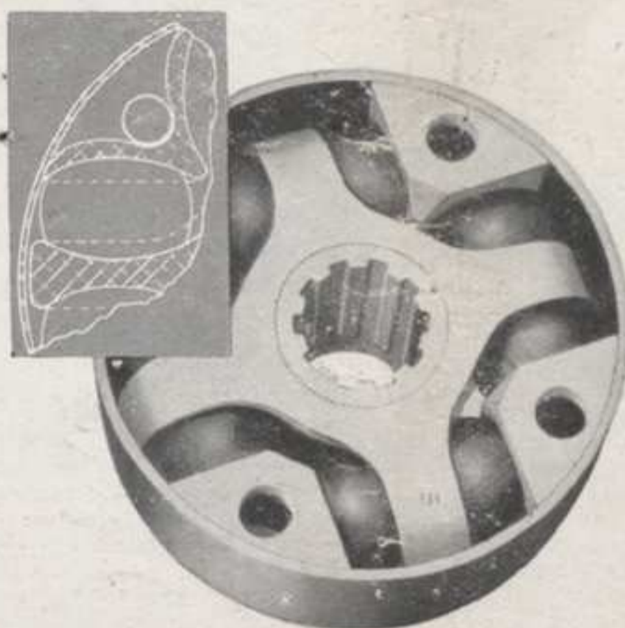
Un joint de cardan Spicer comportant huit billes de caoutchouc est employé à l'extrémité avant de l'arbre de transmission.
